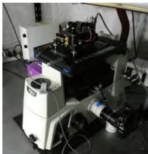
Fig.2 b 高速 AFM/ 蛍光顕微鏡複合機
